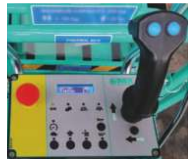
Panou de control pe platformă cu butoane capacitive: simplu și sigur de utilizat
